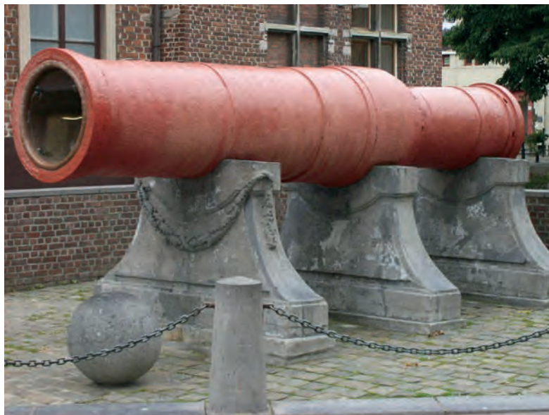
4. KÉP. A STÁJERORSZÁGBAN KÉSZÜLT „PUMHART VON STEYR”, KALIBERÉT TEKINTVE A LEGNAGYOBB ISMERT KOVÁCSOLTVAS BOMBARDA. HOSSZA TÖBB MINT 2,5 M, A KÓNUSZOS CSŐFURAT ÁTMÉRŐJE 76–88 CM
