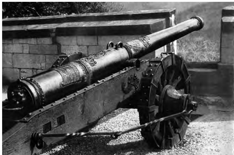
8. KÉP. A „SCHÖNE TREIBERIN”, EGY SZÁSZ MEZEI ÁGYÚ (FELDSCHLANGE) 1521-BŐL. HATFONTOS GOLYÓT LŐTT, ŰRMÉRETE 90 MM. MEGFIGYELHETŐ A CSŐ KÖZEPÉN, A RÖGZÍTÉST BIZTOSÍTÓ FÉLÍVES VASLEMEZ ALATT ELHELYEZKEDŐ CSŐCSAP
