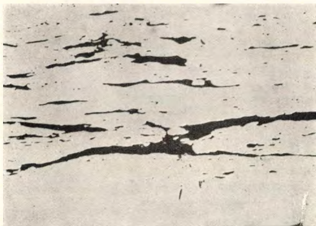
6. ábra. Salakzárványok maratlan hosszcsiszolaton. \bar{N} = 100 \times
