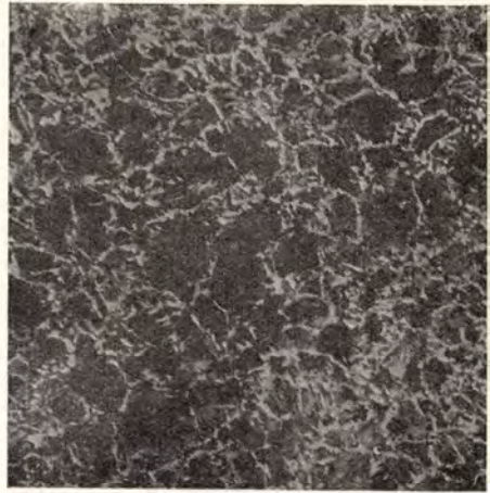
3. ábra. Ferrithálós perlites mikroszövet-szerkezet 100-szoros nagyításban
