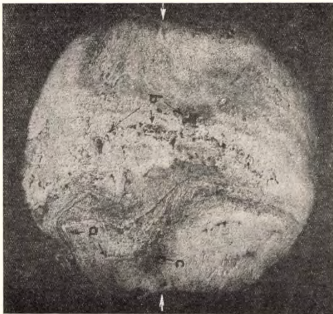
7. ábra. Makrofelvétel az I. keresztmetszeti csiszolatról N = 6 \times (A 4. ábra kb. a fehér nyilak közötti részről készült) a = kovácsolási gyűrődések b = kovácshegesztésből visszamaradt vaskos salakerek c = nagy szénttartalmú rész
