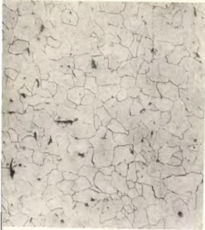
2. ábra. Ferrites mikroszövet-szerkezet 100-szoros nagyításban
