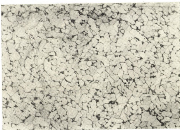
2. A zabla finom ferrites, kevés perlitet tartalmazó szövete. Maratás: nitál, N = 150 \times
