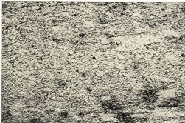
1. 1 nyílhegy hidegen alakított ferrites szövete. Maratás: nitál, N = 600\times
